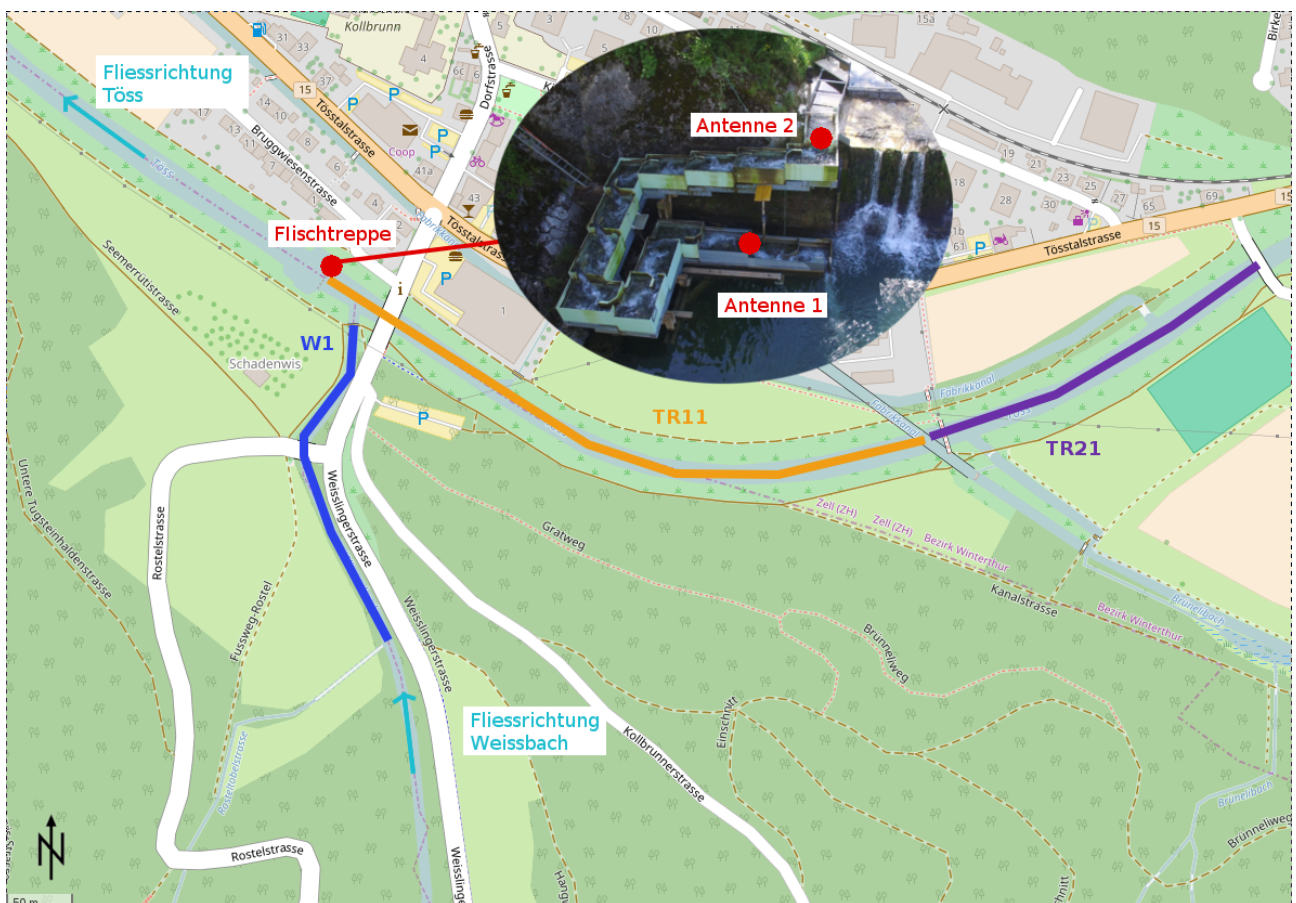
Abbildung 2: Feldstandort mit eingezeichneten Abflussstrecken im Untersuchungszeitraum 2
