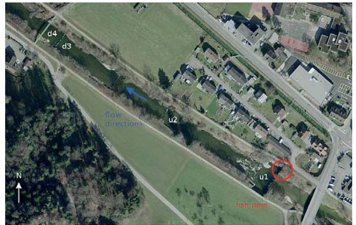
**Bild 4. Versuchsanordnung (u1 = Tiere oben gefangen und im Kolk ausgesetzt, u2 = Tiere oben gefangen und ca. 100 m unterhalb des Hindernisses ausgesetzt, d3 und d4 = Tiere ca. 300 m unterhalb des Hindernisses gefangen und auch dort wieder ausgesetzt).**
