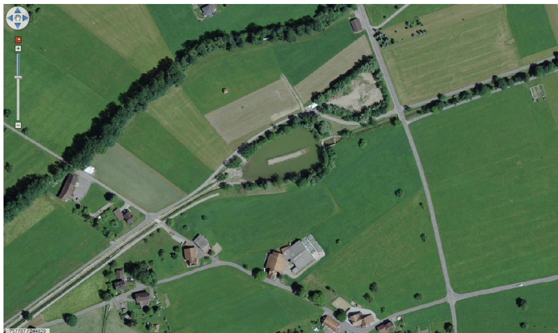
Abbildung 8: Geschiebesammler am Dürrenbach. Geschiebe wurde entnommen, ein Kiesstreifen als Fahrunterlage für den Bagger bei einer künftigen Räumung wurde im Geschiebesammler stehen gelassen. Rechts oberhalb des Sammlers ist der Abtrocknungsplatz erkennbar. Das zuführende (von links) wie auch das wegführende Gerinne (nach rechts) ist stark verbaut (gepflästert). (Geoportal.ch)
