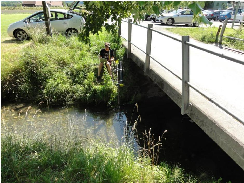
Abbildung 66: Temporäre Messstelle zur Erfassung der Pegeländerungen am Sevelerbach unterhalb der Brücke Eichholz bei Koordinaten 755'625/222'000
