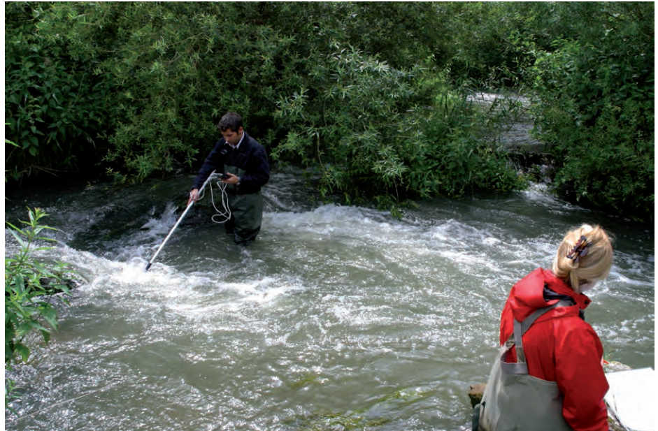
Abb. 49: Hydraulisch überlastete Tümpelpässe mit schießendem Abfluss, extremen Turbulenzen und hydraulischem Kurzschluss; eine Abflussreduzierung kann hier die Passierbarkeit verbessern.
