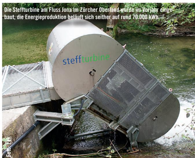
Die Steffturbine am Fluss Jona im Zürcher Oberland wurde im Vorjahr eingebaut, die Energieproduktion beläuft sich seither auf rund 70.000 kWh.
