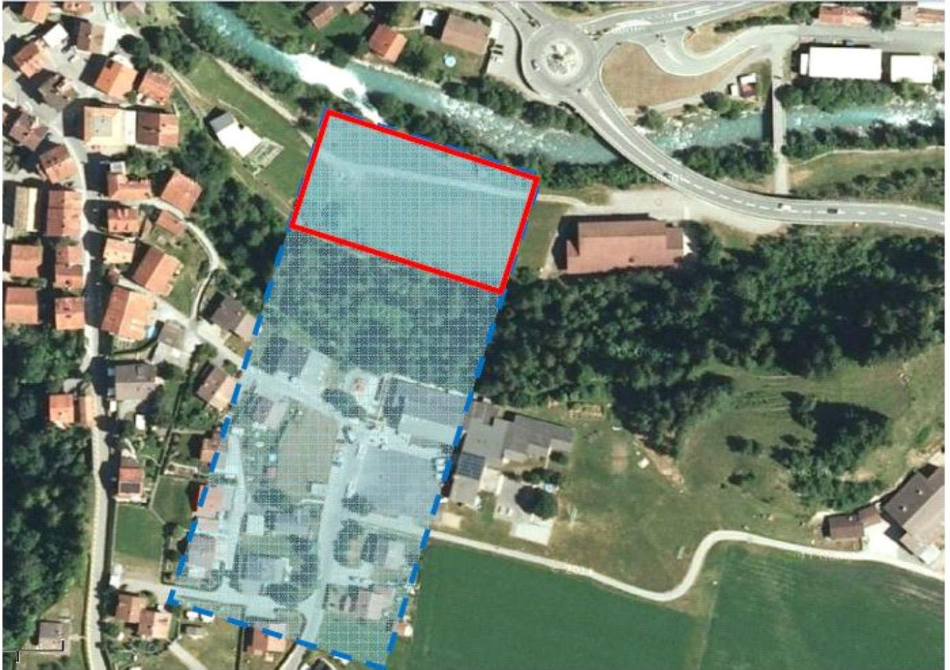
**Bild 1:** Darstellung der Grösse eines Ausgleichsvolumens im Bereich der Zentrale Tiefencastel.
